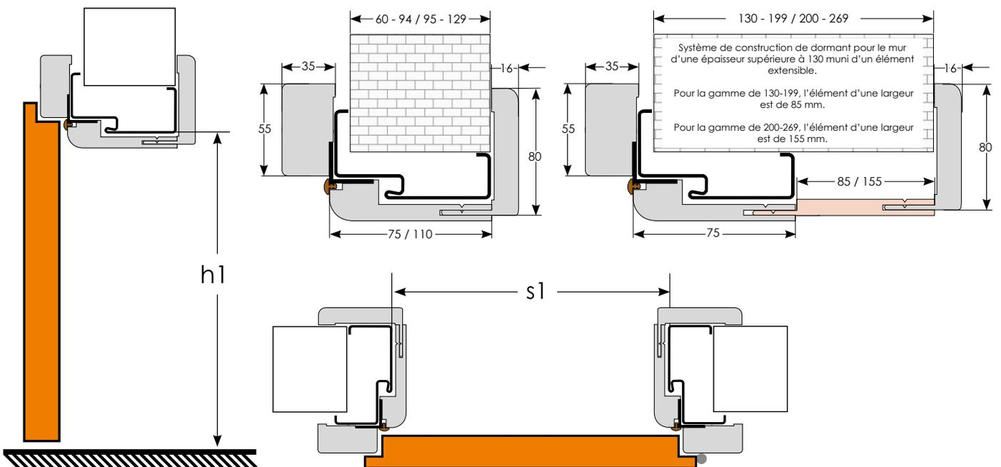
DIMENSIONS À ORIFICES D'UN CADRE MÉTALLIQUE (mm)
